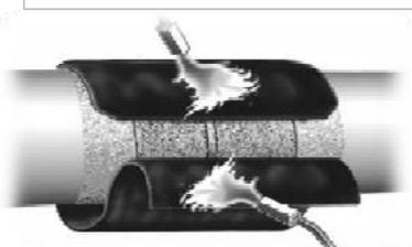
Caliente suavemente el backing de la parte inferior y el lado adhesivo de la superposición. Presione la superposición en su lugar.
