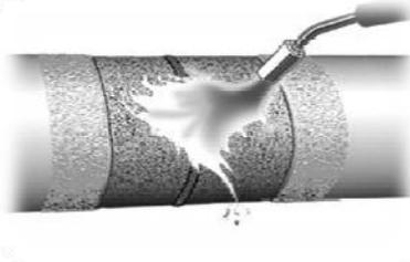
Use una antorcha de propano para precalentar la superficie Min +65°C a Max +75°C
