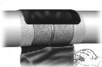
Centre el adhesivo calentado sobre las juntas, se superpone en la posición de la 1 en punto y presione firmemente después de retirar el film de protección.
