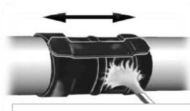
Terminar por calentar la manta entera verticalmente para asegurar una adhesión uniforme.
